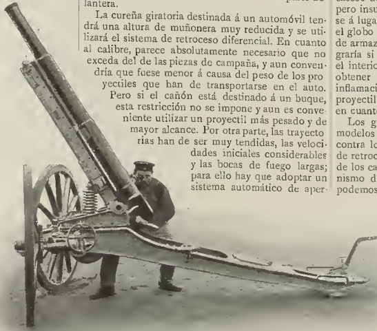
Cañón Krupp de 65 centímetros en batería para el tiro contra los globos
